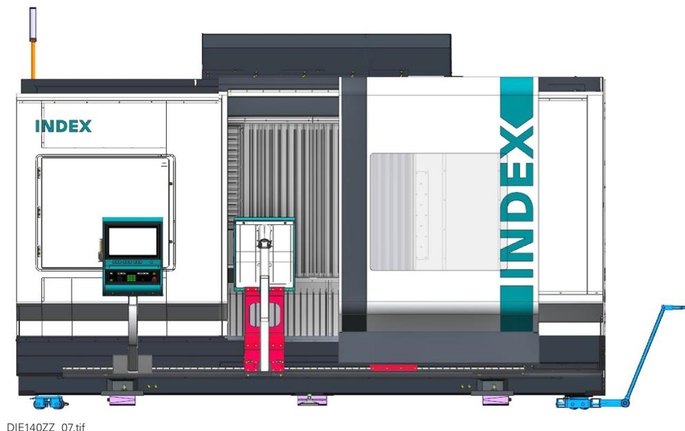
Transportrollen haben den Vorteil einer geringen Ladehöhe, so dass die Maschine mit Hydraulikhebern sowohl aufgeladen als auch abgeladen werden kann. Nachteilig sind die relativ kleinen Räder (Roller), die einen festen, ebenen Boden mit entsprechender Tragfähigkeit voraussetzen und sehr langsames, ruckfreies Fahren bedingen.
