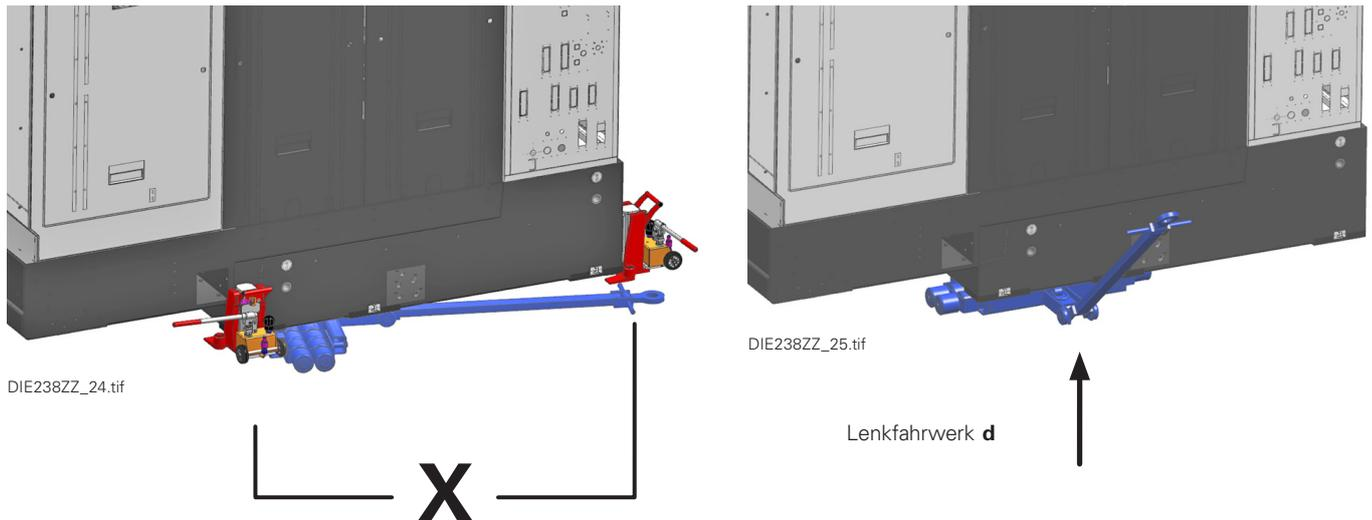
Abb.: Positionen für die Hydraulikheber und Transportrollen
